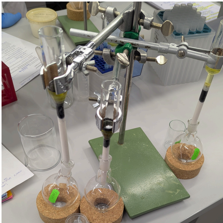
Joonis 3. Ekstrakti puhastamine kolonnkromatograafia abil.
